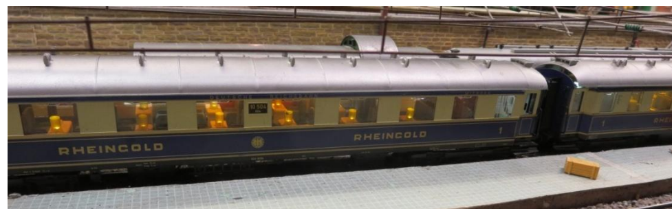
Der er lys i vognene, der primært kommer via elektriske forbindelser mellem vognene og lokomotivets dekoder. For at sikre stabil strøm og dermed lys, er der på hver vogn tilsluttet "nul-forbindelse" via hjulene. Flot med de små lysdioder på bordene.
