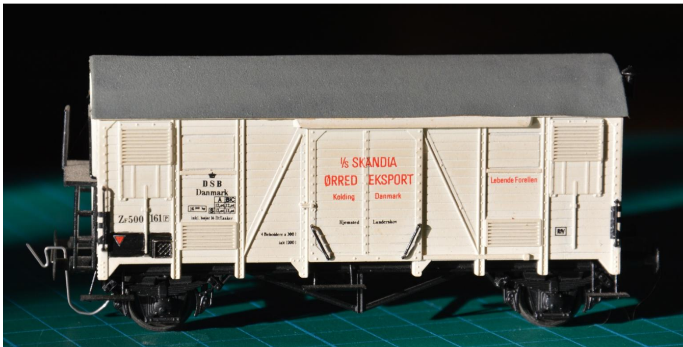
ZF 500 161. Tæt på at være den nemmeste ombygning, som jeg har lavet! Markering af fire læsselemme, nye fritstående håndtag, skorsten, et lille vindue, fjedrende puffer, Rp 25 hjul, strækbånd, trin, det hele afsluttet med en gang hvid maling og fine påskrifter. Vognen kom senere som (om)byggesæt fra "På Sporet". Modellen er lavet i 1986.
