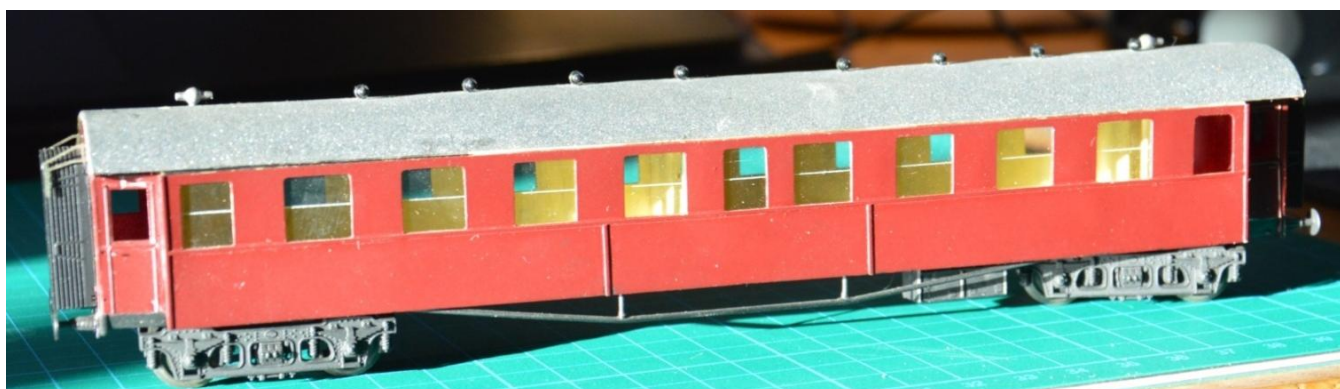
CO 2743. Vognen er bygget efter en byggebeskrivelse i Lokomotivet nr. 8. 1985. Vognkassen er bygget i 0,5 mm. glat card. Der burde nok have været lamineret yderligere en 0,5 mm plade under vindueskanten. Det havde givet vognkassen større styrke!
