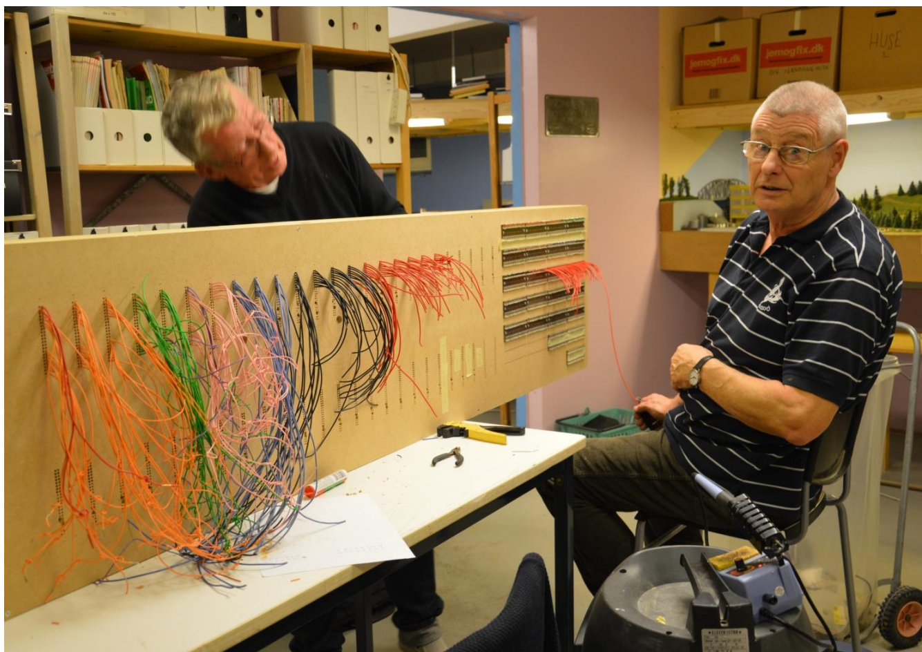
Hvert eneste af de små huller skal indeholde en ledning. De lodrette toradede hulrækker repræsenterer hver en printsokkel. Her skal der sidde printplader med elektronik til styring af skifter m.m.
