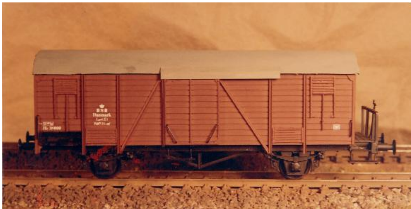
En ganske spændende vogn, der startede sit liv som tysk fiskevogn, så blev den en dansk ditto, endelig købte DSB den, fjernede midterakslen, byggede vognkassen som en 1A vogn og gav den litra HF 38 000, Jørgen byggede modellen i 1986. Undervognen er en Liliput HD undervogn, der er forlænget til vores brug. Desværre "forsvandt" vognen under et udlån et par år senere – så alt vi har, er dette billede.
