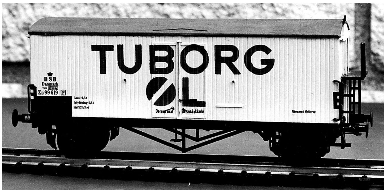
Ikke en Heljan ølvogn, men en hjemmegjort vognkasse på en opdateret Liliput HD undervogn.
