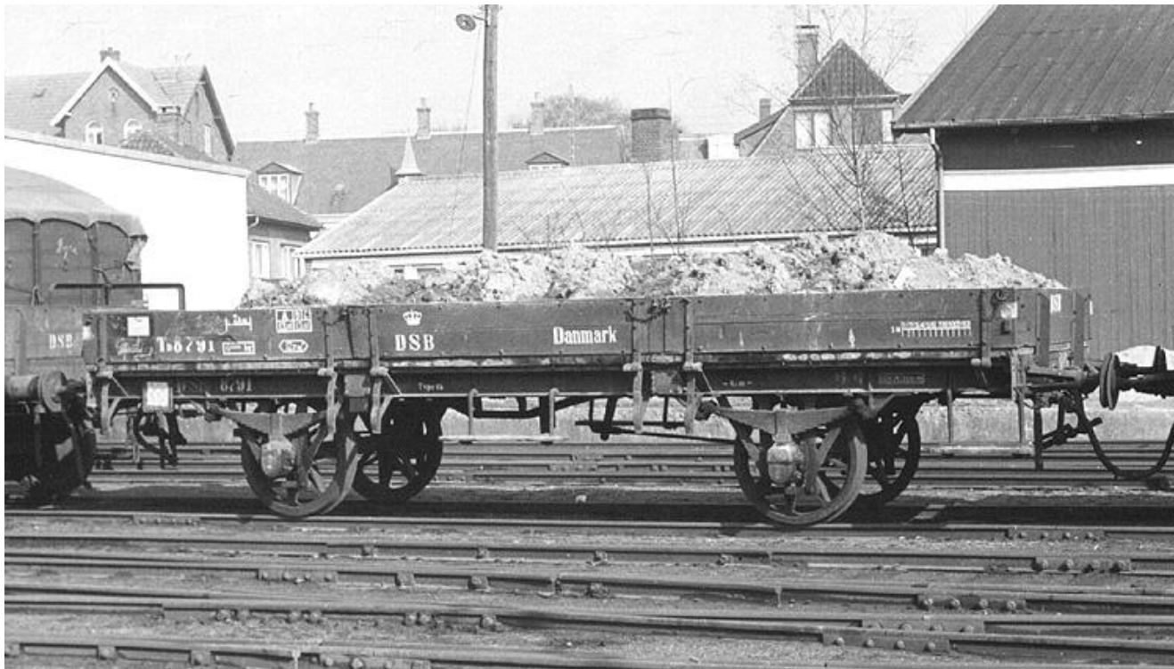
TD 8791. I Frederikssund, "den evige grusvogn" En skøn gammeldags vogn med stjerne hjul, spinkle åbne akselgafler, dråbelejer og kurvpudder. Bygget af Scandia 1907 til KSB T 427 og udrangeret i 1965. Foto.: Hans Gerner Christiansen.
