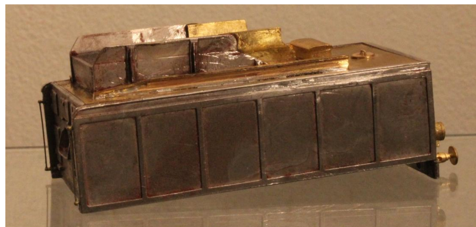
Den rå, men næsten færdige kedel med en stor del af detaljerne monteret. Bemærk de mange borede huller i fyrkassesvøbet.
