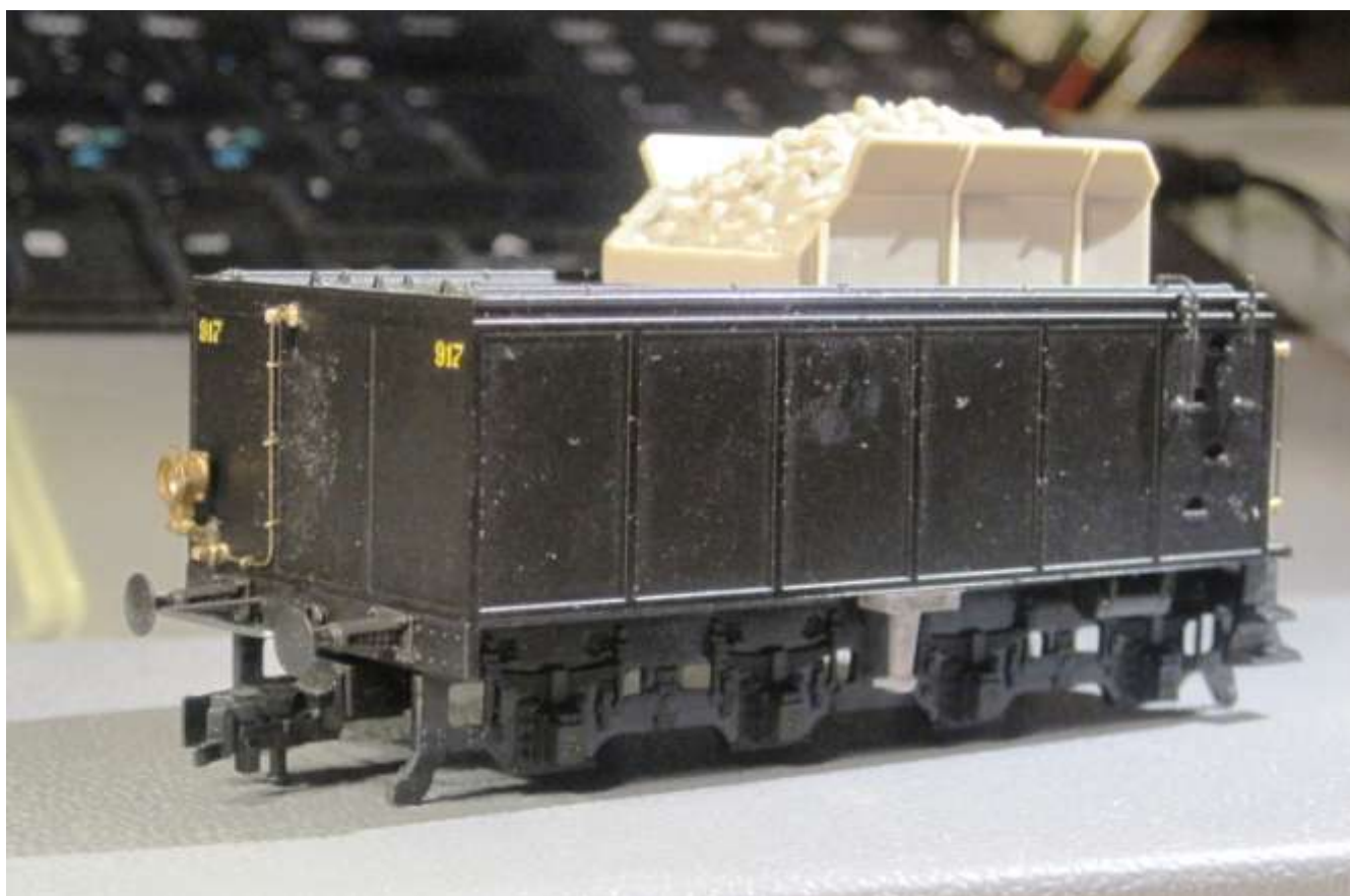
Tenderen med ændrede "ophæng" mellem 2. og 3. aksel, donkraft, fjederpuffer, nederste lanterne, Fordelerdåse med kabel til øverste lanterneholder, nye balustre på tenderens forkant, ny kulkasse og holder til fyrbøderens værktøj på den anden side.
